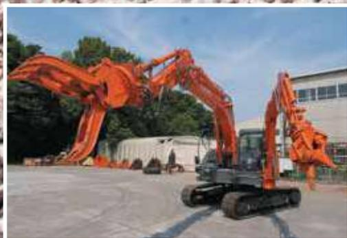
Экскаватор ASTACO с двумя стрелами для комплексной работы
